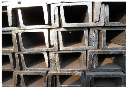
*Вес швеллера горячекатаного с уклоном внутренних граней полок и с параллельными гранями полок ГОСТ 8240-89*
